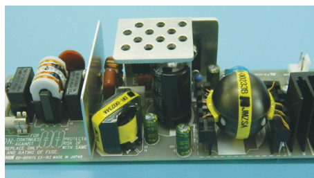
CO2削減に貢献する業界初球状トランス搭載LED照明用電源
